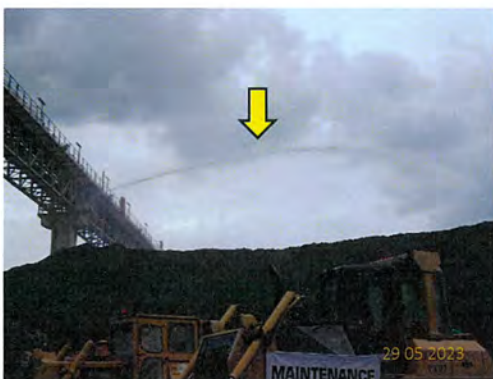
ภาพที่ 2-9 การฉีดพ่นน้ำบริเวณสายพานโปรยถ่านหิน ลงสู่กองถ่านหิน
